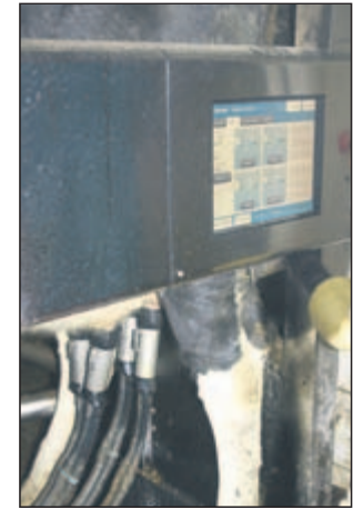
Wie viel Milch die vier Melk-Becher aus den vier Zitzen holen, wird auf dem Bildschirm der neuen Maschine angezeigt.
